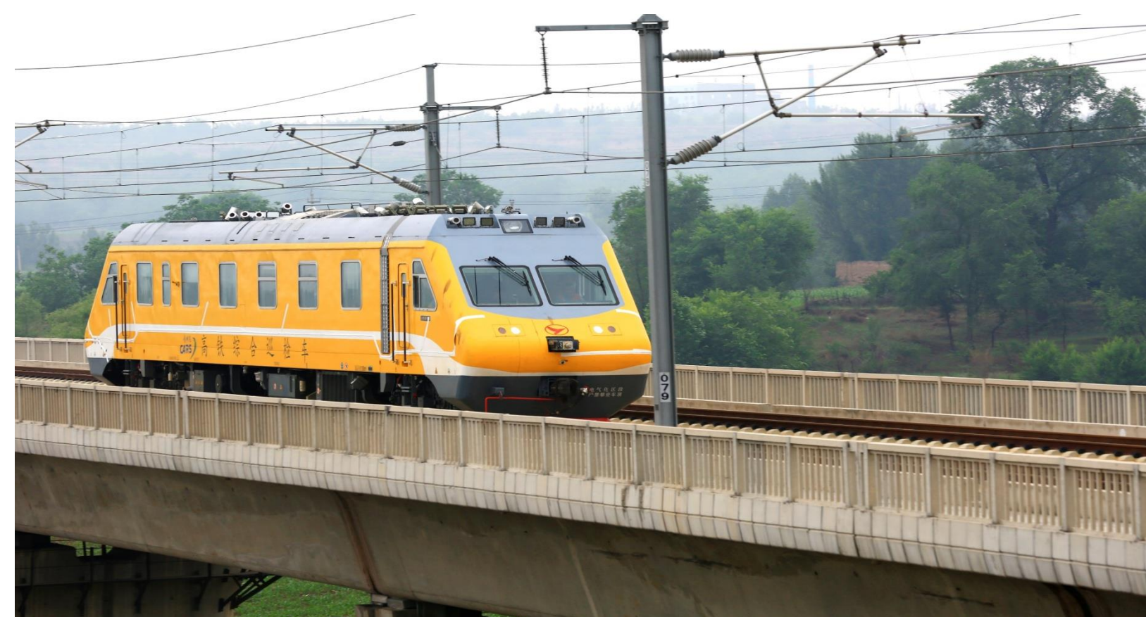
高铁综合巡检车
