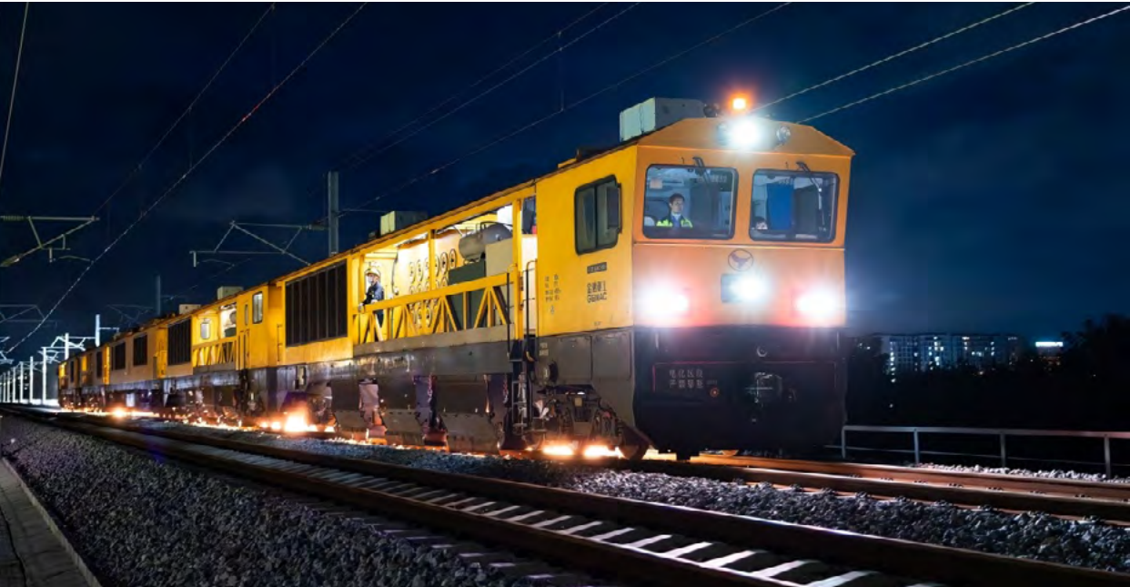
铁路钢轨打磨车施工作业
